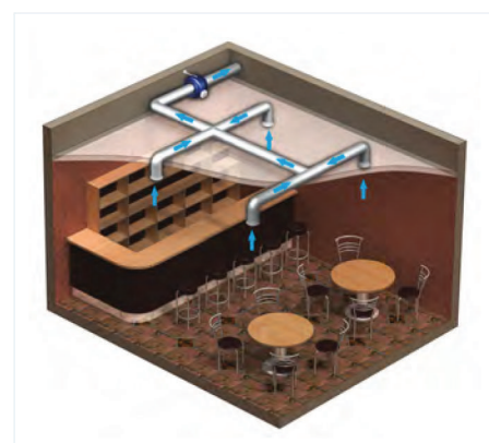
Wariant zastosowania wentylatora VKM w kawiarni.
